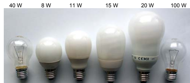
Rys. 5. Zestawienie wymiarów tradycyjnych żarówek ze świetlówkami kompaktowymi o kształcie przypominającym żarówkę
